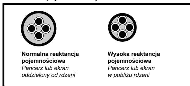
Rysunek 4-17 Wpływ konstrukcji kabla na reaktancję pojemnościową
