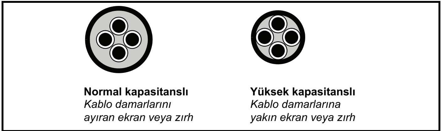
Şekil 4-4 Kapasitansı etkileyen kablo yapısı
