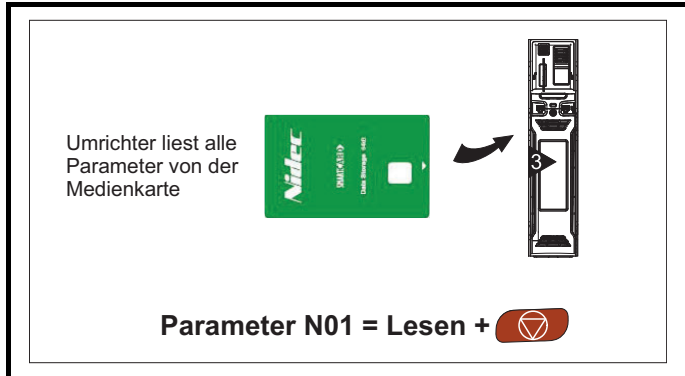
Abbildung 4-3 Booten und automatisches Speichern des Aufzugsumrichters mittels SMARTCARD / NV-Medienkarte
